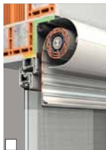
Standardmontage als Linksroller in die Laibung (Abb. XP-System im monolithischen Mauerwerk mit Sonderausstattung Insektenschutzgitter)
